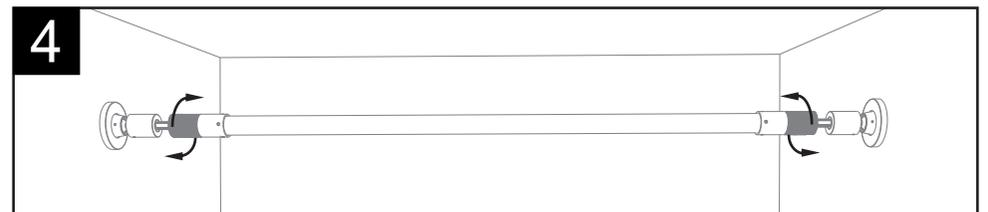
4 安装好灯具后用拉力头上的旋转件将发光管拉直，旋转时候，要握住发光管，以免发光管同步旋转导致线路扭断（两端能把发光管拉长约40mm）；打开电闸，亮灯试亮。
