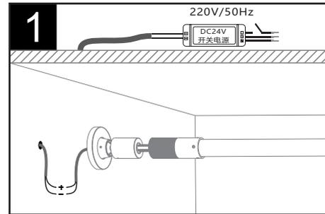
1 在安装位置预留供电线，将供电线连接灯具，接入DC24V电压，打开电闸，试亮，确保电路畅通。
