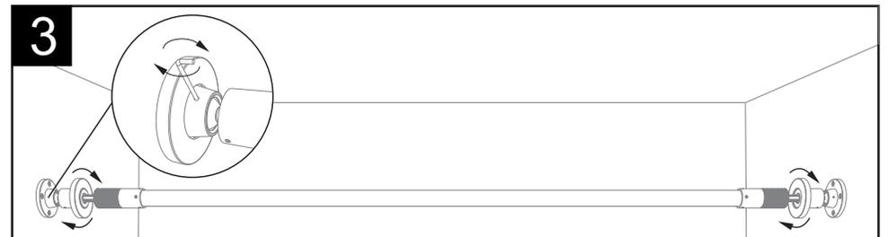
3 安装好灯具后，将吸顶端盖拧回吸顶盘；拧紧吸顶盘上的机米螺丝，将拉力头固定住。（这颗机米用于控制拉力头的调角，安装前发现不能调角可松开机米螺丝）
