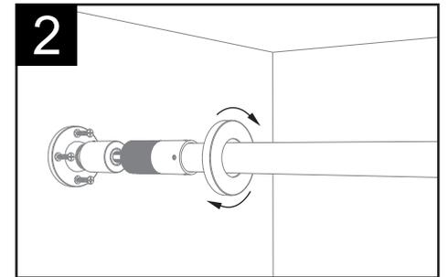
2 拧开端盖，用配螺丝钉将灯具两端吸顶盘固定好。
