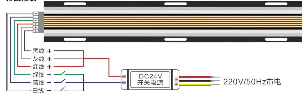
※此接线方式为非调光；若需调光，请根据所需的调光方式另行接线。
