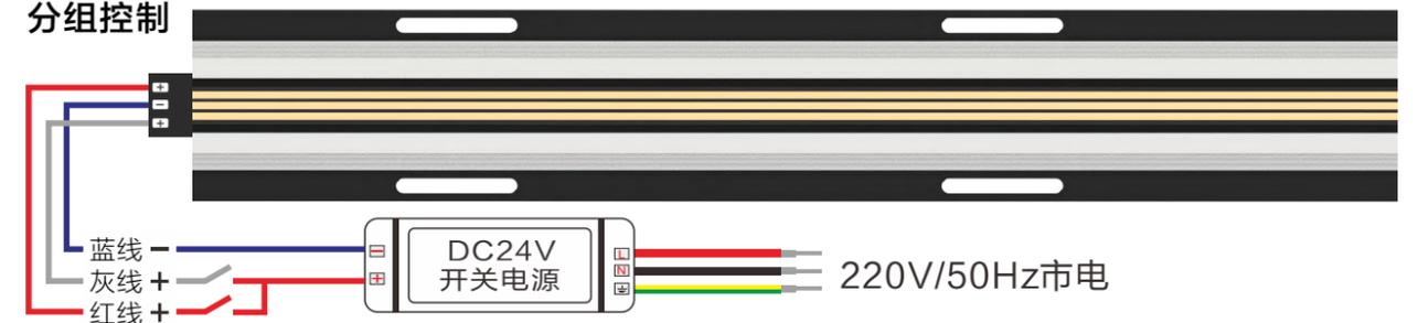
※此接线方式为非调光；若需调光，请根据所需的调光方式另行接线。
