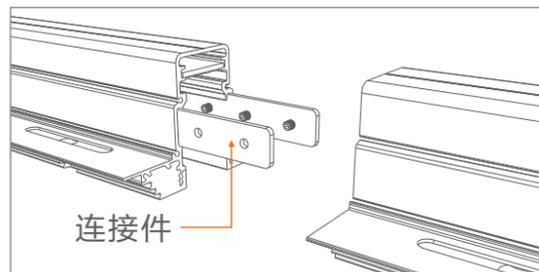
将连接件插入轨道连接槽，用机米螺丝锁紧，再将所需拼接的轨道对准连接件插入，再锁紧机米螺丝；
