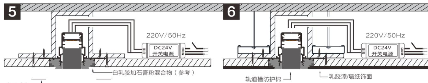
用白乳胶加石膏粉混合(参考)填补轨道与天花板之间的缝隙,再用专用砂布粘上补好,缝口处补好后待干透.
