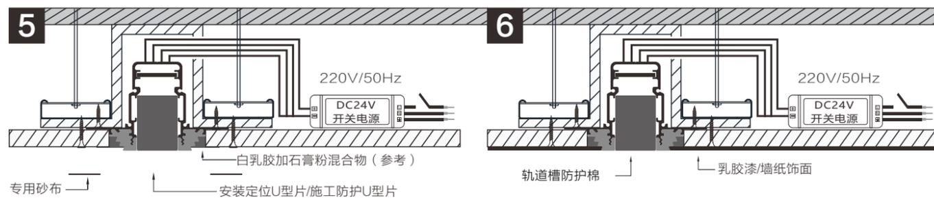
5 用白乳胶加石膏粉混合 (参考) 填补轨道与天花板之间的缝隙,再用专用砂布粘上补好,缝口处补好后待干透。
