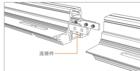
将连接件插入轨道连接槽,用机米螺丝锁紧,再将所需拼接的轨道对准连接件插入,再锁紧机米螺丝;
