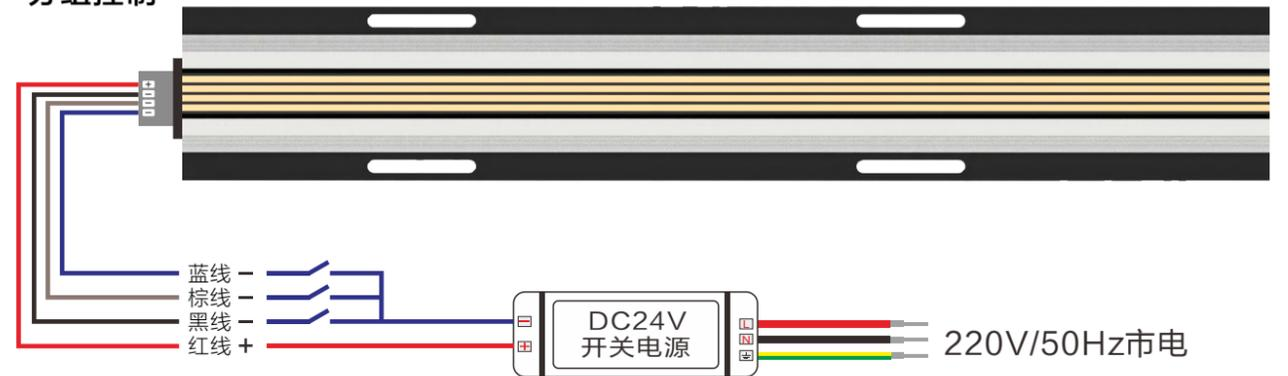
※此接线方式为非调光；若需调光，请根据所需的调光方式另行接线。
