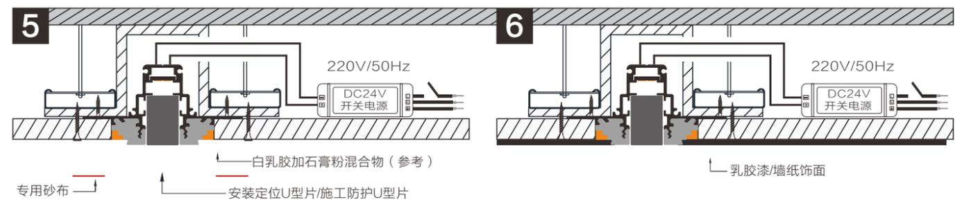
用白乳胶加石膏粉混合(参考)填补轨道与天花板之间的缝隙,再用专用砂布粘上补好,缝口处补好后待干透。
