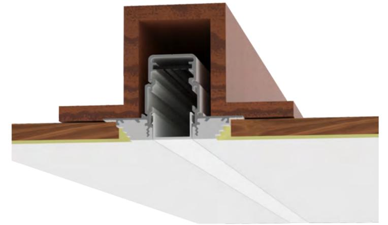
原创石膏轨道，完美解决批灰破裂/脱落问题；
