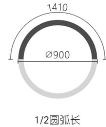
注: 直径900mm为轨道灯具槽外径尺寸。
